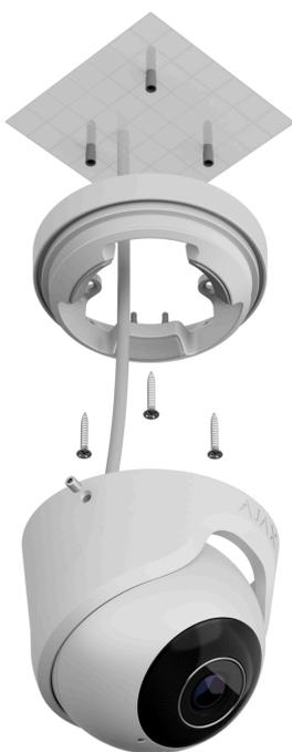
5. Collocare la custodia della telecamera nel supporto, assicurandosi che la lente della telecamera sia rivolto verso l'area protetta. Fissarlo in posizione stringendo le due viti del supporto con la chiave esagonale in dotazione ( $\varnothing$  2 mm).
