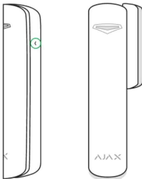
Se le componenti del rilevatore si installano su piani perpendicolari (su stipiti/telaio), utilizzare il magnete piccolo compreso nel kit. La distanza tra il magnete e il rilevatore non deve superare 1 cm.
