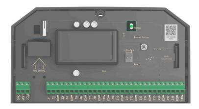
L'indicatore Led di MultiTransmitter può illuminarsi di bianco, rosso o verde a seconda dello stato del dispositivo.
