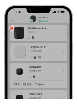
Se il modulo di integrazione presenta un malfunzionamento (ad esempio, non c'è connessione con l'hub tramite il protocollo Jeweller), l'applicazione Ajax visualizzerà un contatore di malfunzionamenti nell'angolo in alto a sinistra dell'icona del dispositivo.
