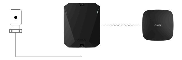
MultiTransmitter può essere utilizzato per collegare pulsanti antipanico e pulsante di aiuto d'urgenza, rilevatori di movimento da interno ed esterno, nonché rilevatori di apertura, vibrazione, rottura vetri, gas, allagamento, incendio e altri.
