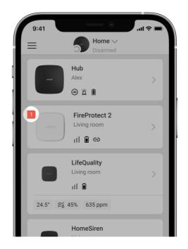
Se viene rilevato un malfunzionamento di FireProtect 2 (ad esempio, non c'è connessione con l'hub), un contatore di malfunzionamenti viene visualizzato nel campo del dispositivo nell'app Ajax.
